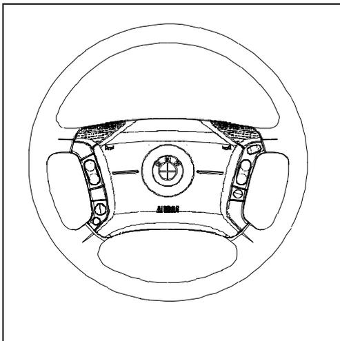
**Airbag- Multifunktionslenkrad, d = 385 mm >(1)**
