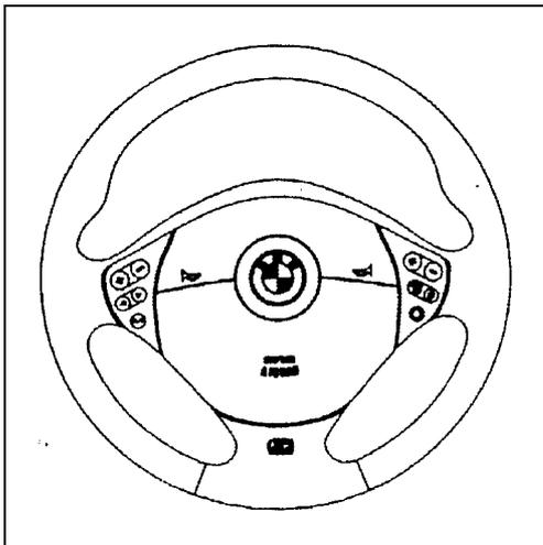
**M-Technik-Airbag-Sportlenkrad, d = 379 mm >(2) (4) (5)**
