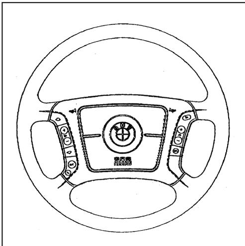
**Multifunktions-Airbag-Lenkrad, d = 385 mm >(1)**
