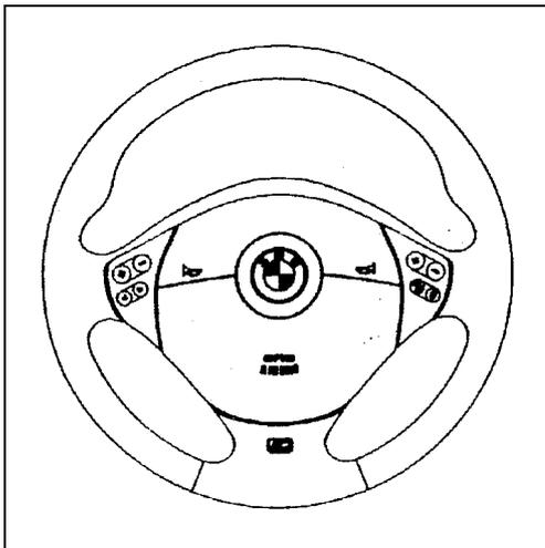
**M-Technik-Airbag-Sportlenkrad, d = 385 mm >(2) (4)**
