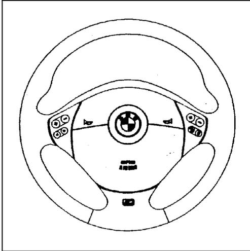
**M-Technik-Airbag-Sportlenkrad, d = 279 mm >(2) (4) (5)**
