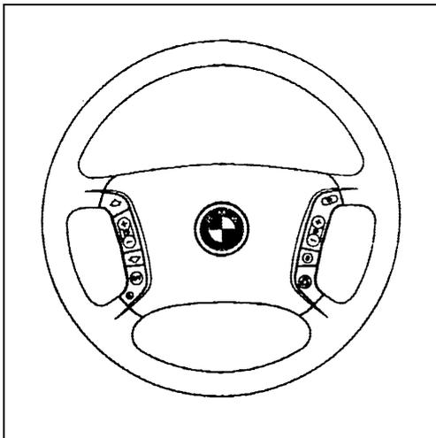
**Multifunktions-Airbag-Lenkrad, d = 395 mm >(1)**
