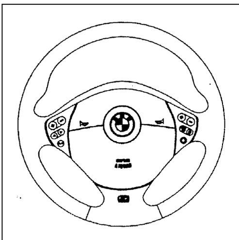
**M-Technik-Airbag-Sportlenkrad, d = 385 mm >(2) (4)**
