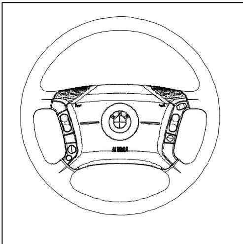
**Airbag-Multifunktionslenkrad, d = 385 mm >(1)**
