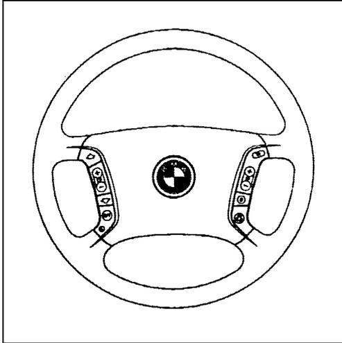
**Multifunktions-Airbag-Lenkrad, d = 395 mm >(1)**
