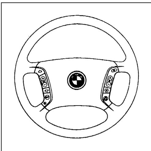
**Multifunktions-Airbag-Lenkrad, d = 395 mm >(1)**
