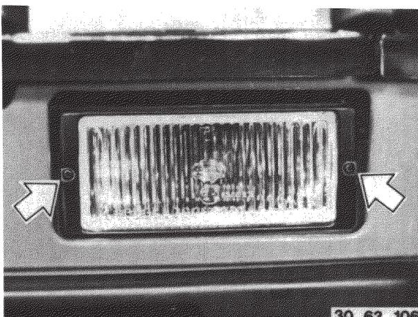
Schrauben (Pfeil) lösen, Scheinwerfereinsatz ausheben.
